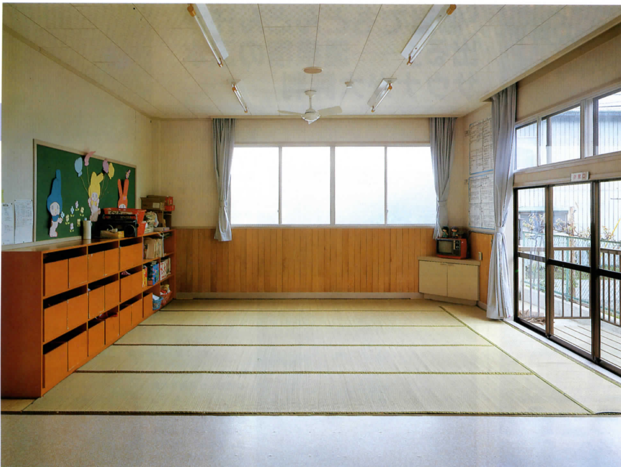
④ ほふく室。床暖房の床にゴザ敷きです 床・ゴザ敷き
