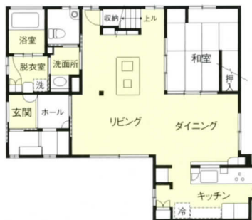
床暖房設置箇所
