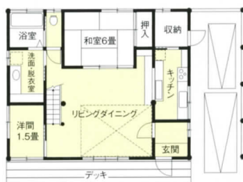
床暖房設置箇所
